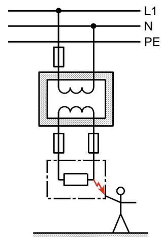
Als Voraussetzungen für die Schutztrennung muss eine sichere Trennung vom (geerdeten) Versorgungsnetz gewährleistet sein.
